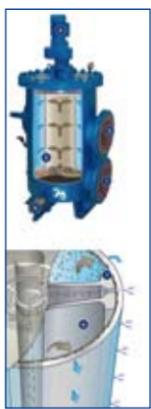
eficaz, necesita una sobrepresión operativa en el lado de salida (lado limpio) del filtro. La magnitud de la sobrepresión operativa depende del medio que va a filtrarse y de la finura del filtro. El enjuague en contracorriente finaliza tras unos pocos segundos. En cada caso sólo se limpia la parte del elemento filtrante cubierta por la tobera de enjuague. La superficie de filtro restante sigue estando disponible para la filtración. Así, se garantiza un proceso de filtrado continuo.
