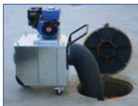
IVERNA 2000 SL ha desarrollado, el Motovent, equipo de ventilación portátil autónomo para la extracción de aire contaminado y de gases tóxicos de pozos y colectores. Este equipo está concebido tanto para vaciar como para rellenar el ambiente en pozos, colectores de aguas y de residuos, así como para facilitar el trabajo a los operarios y evitar así cualquier riesgo de intoxicación o fallecimiento.
