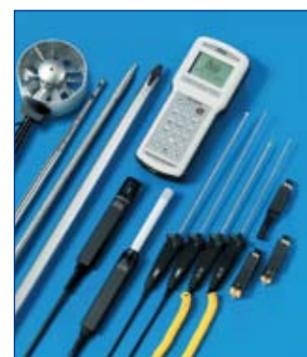
una memoria de 32.000 lecturas por canal, presenta funciones de máximo, mínimo, promedio, diferencial, medidas relativas, hold y apagado automático. Está fabricado en ABS y goma (protección IP64). Funciona con 4 baterías tipo AA o de forma opcional, un adaptador a red 100-240Vca salida 9Vc/250mA. Pesa tan sólo 300gr y sus dimensiones son 250 x 100 x 50mm, e incluye maleta de transporte.
