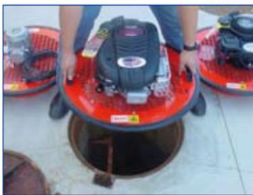
aparato en la boca, que gracias a su junta de EPDM con colchón de aire se adapta al terreno. Al mismo tiempo, abrir otra tapa contigua para que se produzca la extracción del aire y hacer las renovaciones del mismo. Para mayor eficacia, instalar un Terminal MOTOVENT junto con dos balones obturadores para que el paso de aire haga forma de "U". POZOVENT fue nombrado como "innovación tecnológica" en la edición 2008 de la feria de SMAGUA.
