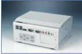
Una de las últimas incorporaciones es el ARK-3420, que se presenta en tres versiones, montando microprocesadores ULV Intel Core™ 2 Duo 1,6 GHz, ULV Intel Core™ 2 Duo 1,06 GHz. o Mobile Intel Celeron 2.0 GHz de bajo consumo, por lo que no necesita ventilador. El chasis de aluminio de estos mini PCs actúa como disipador de calor.
