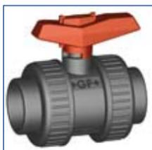
de cada aplicación, Georg Fischer crea diferentes versiones de su válvula de bola 375. Así, los profesionales del tratamiento del agua, como de otras aplicaciones relacionadas con el agua, pueden elegir entre los modelos de PVC-U con manguitos roscados Rp, con manguitos largos para fusión a tope, con bridas estriadas fijas de PVC-U y con manguitos encolables ISO/DIN, entre otros.
