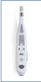
Incorporan sensores para la medición de temperatura ambiental, Humedad, Monóxido de carbono (CO) y Dióxido de carbono (CO2), memorizando los datos adquiridos hasta un máximo de 20.000 en el intervalo seleccionado, o bien transmitiendo los datos directamente al PC, mediante el software DeltaLog13 incluido en el suministro. Los equipos se suministran con pilas recargables, cargador a 230Vac, instrucciones y maletín.
