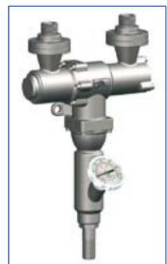
QUILINOX, con su representada empresa CSF, ofrece el mezclador Agua-Vapor serie "M", un aparato que consiste en mezclar agua fría y vapor, obteniendo instantáneamente agua caliente para limpieza de mataderos, frigoríficos y salas de despiece.
