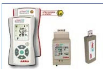
Los nuevos productos Wireless TEMP de Julabo ofrecen comunicación inalámbrica con casi todos los dispositivos Julabo. El único requerimiento es una interfaz RS232 en el dispositivo de control de temperatura. Si esta conexión está disponible, se pueden controlar y monitorear inalámbricamente a un bajo costo circuladores, recirculadores de refrigeración y sistemas de control de temperatura.
