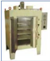
Estas estufas están construidas por módulos de chapa plegada con refuerzos y rellenos de fibra cerámica, de espesores variables en función de la temperatura de trabajo. El habitáculo de calentamiento está al nivel de trabajo, para la introducción de las cargas mediante cestas, bandejas, carros o soportes varios. El medio calefactor se sitúa en las zonas laterales o parte superior, que dependiendo del modelo puede
