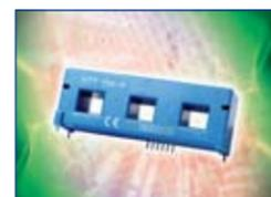
Los transductores HTT tienen tres aberturas de 12 x 10mm para los conductores primarios y están montados de forma segura sobre cuatro patillas metálicas soldadas a la PCB. Las conexiones secundarias para la fuente de alimentación, 0 V y las tres salidas
