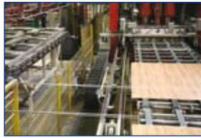
la serie 5050 del sistema "E4/4" de igus. Estas cadenas portacables son particularmente aptas para grandes cargas, trayectos de desplazamiento largos y entornos con un alto grado de suciedad o humedad. Las piezas laterales de la cadena portacables están unidas unas
