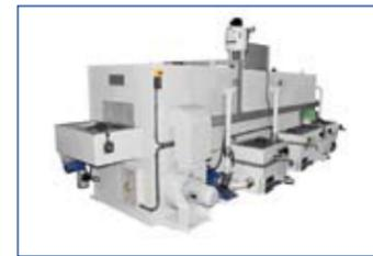
Una vez más en el estudio del diseño y fabricación de maquinaria para el tratamiento de superficies y metales, Bautermic sorprende con sus túneles continuos de lavado y desengrase de piezas industriales. Estas máquinas LCB son de tipo túnel para trabajar en infinidad de tratamientos y son ideales para la limpieza de todo tipo de piezas con altas prestaciones.
