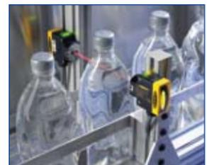
El nuevo sensor fotoeléctrico de Banner Engineering detecta la presencia o ausencia de agua o de líquidos que contengan este elemento, en recipientes transparentes y translúcidos, de vidrio o plástico. Una versión de alta potencia, puede detectar líquidos con base de agua en muchos recipientes opacos, ya sean de vidrio o de plástico.
