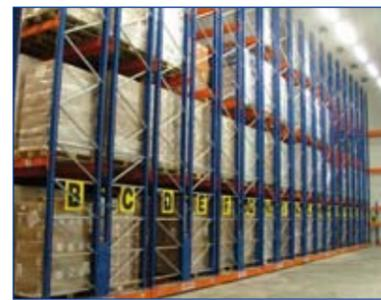
está equipada con un cuadro eléctrico situado cerca de las bases móviles, que contiene todos los componentes necesarios para la alimentación y el control del equipo eléctrico. Estas estanterías van provistas de sistemas de seguridad mediante células fotoeléctricas que impiden el movimiento del sistema en caso de que exista algún obstáculo por caída de mercancías a los pasillos o por la situación del personal.
