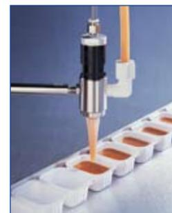
Los sistemas de válvulas EFD ayudan a dosificar cantidades controladas y consistentes de productos alimenticios y bebidas o fluidos de ensamblaje como cianoacrilatos, solventes y adhesivos curados por UV, utilizados en el empaque y operaciones de producción.
