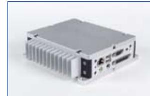
interface VGA. Con respecto a su diseño mecánico, el ARK-4180 es de muy reducidas dimensiones y peso, ya que su diseño parte de tarjetas CPU en formato PC/104, confiéndole gran facilidad y variedad de instalaciones. Existen multitud de aplicaciones donde se requiere un ahorro de espacio, como por ejemplo: máquinas de vending, máquinas recreativas, PCs para vehículos, náutica, etc.
