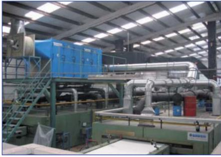
recuperado por medio de este mecanismo de recuperadores de calor. De ésta manera se produce un ahorro energético del 30%, una disminución de la polución hasta el 40% y en muchos casos un aumento de producción.
