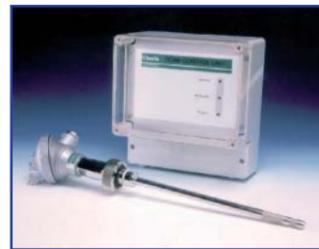
Los sensores de Charis pueden trabajar en condiciones de proceso de hasta 170 °C y 20bar y pueden usarse en zonas clasificadas. También disponen de una versión para laboratorio o planta piloto. Entre sus aplicaciones destacan la detección de espuma en fermentadores de
