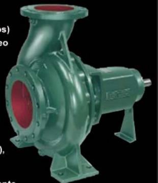
El sistema BACK PULL OUT y el acoplamiento al motor mediante acoplamiento elástico y distanciador separador, suministrado bajo pedido, facilitan el desmontaje de la hidráulica sin desconectar el motor y el cuerpo de bomba de la tubería.
