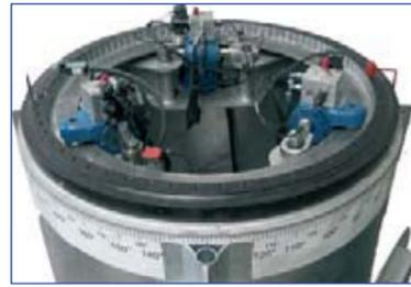
Dado que los seguidores solares realizan movimientos paso a paso, y están más tiempo inmovilizados que en movimiento, es preciso la utilización de un freno negativo.
