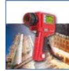
La longitud de onda en la que trabaja ha sido cuidadosamente seleccionada, centrada en 3.9 µm para que minimice los errores causados por las bandas de absorción/emisión presentes en la combustión de gases. Dispone de un indicador retro-iluminado que proporciona una indicación del estado y configuración del termómetro, junto con indicación simultánea de 4 modos de medida: continuo, pico, promedio y valle.
