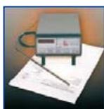
El exclusivo software es muy simple de usar y el ajuste de la sonda digital permite que el sistema alcance una precisión de 0,3° C o superior. El Tempmaster-100 usa baterías recargables y permite que se logre el rendimiento estándar de laboratorio en el emplazamiento. Está orientado a las industrias farmacéutica, médica y de procesamiento de alimentos, laboratorios de petróleo y moto-
