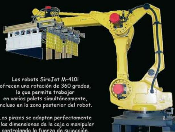
Los robots SiroJet M-410i ofrecen una rotación de 360 grados, lo que permite trabajar en varios palets simultáneamente, incluso en la zona posterior del robot.
