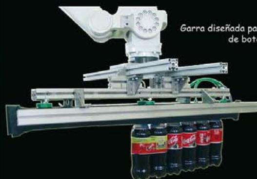
Garra diseñada para el transporte de botellas.
