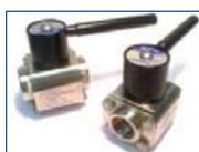
Se trata de válvulas de bola de tres piezas unidas por pernos que permiten realizar la sustitución de los asientos o bien la limpieza interior de forma muy fácil sin mover las conexiones laterales. Su diseño de paso total evita la pérdida de carga provocada por la reducción del paso.
