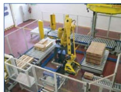
za de manipulación para manejar las cajas, sacos y palets. Una vez confeccionado el palet, éste se transfiere a la enfardadora mediante caminos de rodillos para su embalaje. La automatización garantiza la optimización de la producción asegurando un alto rendimiento en
