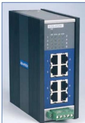
Su diseño y reducido tamaño permiten montarlos en rail DIN o panel. Su temperatura de trabajo está entre 0°C y 70°C, excepto un modelo con extensión del rango de temperatura (EDG-6528I) que puede trabajar entre -40°C y 85°C, permitiéndole trabajar en ambientes industriales más duros. Ofrecen una protección contra sobre tensiones de alimentación de 3.000 VDC y una protección ESD de 4.000 VDC.
