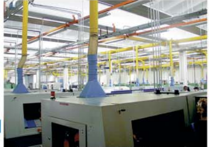
Instalación centralizada para neblinas de aceite en centros de mecanizado
