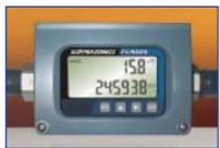
En aplicaciones en que el fluido es limpio, pero en ocasiones circula con sólidos o gases en suspensión, el Fusion realiza la detección automática de la presencia de partículas y cambia del modo Tiempo de Tránsito al modo Doppler para seguir manteniendo la fiabilidad de la medida.
