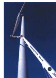
mayor alcance vertical en España, con una capacidad de carga de hasta 400 Kg., siendo posible trabajar con mayor seguridad y confort en los parques eólicos. Junto con la Bronto, los modelos de 50, 56,62 y 70 metros de altura son muy utilizados en los parques eólicos, no solo por su elevación, si no por que incorporan las últimas medidas de seguridad.
