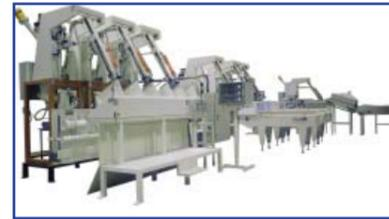
La nueva generación equipos control pesaje MCB+. Equipos de control de peso para ensacadoras, con pantalla táctil de fácil uso y aprobación según nueva Certificación Europea MID para básculas ensacadoras.
