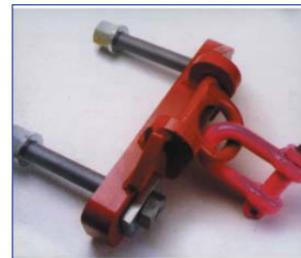
base que se fija mediante dos tornillos imperdibles a la brida del sector tubular del aerogenerador, admitiendo espesores de brida de 50 mm. hasta 125 mm. y con una distancia variable entre agujeros que se compensa gracias al agujero rasgado de la placa base, donde el tornillo se ajusta a la distancia requerida.
