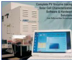
Los simuladores solares iluminan uniformemente superficies desde 50x50mm con una irradiancia de al menos un sol y sus filtros de masa de aire (AM 1.5G) proporcionan espectros que se adecuan a los estándares de la ASTM. Su innovador diseño óptico proporciona mayor irradiancia en el plano de trabajo que los simuladores convencionales. Se trata de equipos compactos, seguros y de sencillo
