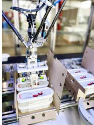
larlos por debajo, o bien recoger y depositar los productos sobre las fajas, mediante un sistema de "pick & place".
