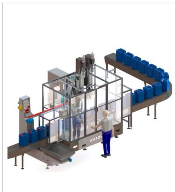
Máquina totalmente automatizada para el llenado ponderado y en línea de producción de botes, cubos, bidones, barriles e IBC sobre paleta. El modelo Robot Filler está diseñado para altas producciones con un alto nivel de automatización.
