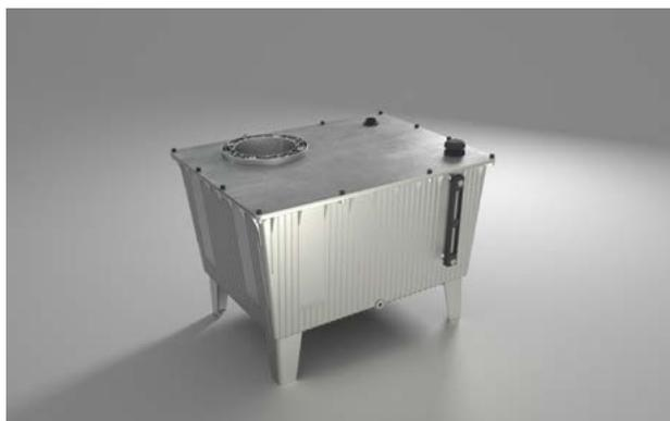
Los depósitos de aluminio de tamaño nominal NG130 tienen un volumen útil de 123 l. El depósito NG130 alcanza un rendimiento de refrigeración "integrado" de 2,1 kW a  $Dt = 40^{\circ}C$ , y ellos gracias a las paredes finas especialmente diseñadas para su estructura. Otras ventajas son el bajo peso de sólo 25 kg, la facilidad de manejo y la apilabilidad de los depósitos. Esto no sólo ahorra costes de transporte, sino también espacio de almacenamiento.
